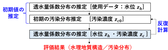
第1図 汚染分布と水理地質構造の同時推定の流れ
